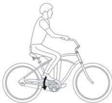
Para uma travagem mais forte, os braços do pedaleiro devem estar na horizontal quando é aplicada a travagem. O pedaleiro vai rodar um pouco antes de ativar o travão, pelo que é melhor aplicar a travagem com o pedal traseiro um pouco mais alto do que a horizontal.
