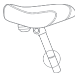
Rysunek 1.2: Ogranicznik maksymalnego wysunięcia sztycy podsiodłowej.
