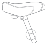
Afbeelding 1,2: De minimale insteekdieptemarkering
