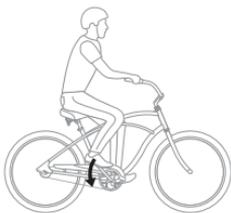
制動力を最大限高めるためには、ブレーキをかける前にクランクアームを水平に保ってください。クランクはブレーキがかかるまでにわずかに回転するため、後ろ側のペダルを水平よりもやや高くしてブレーキをかけ始めましょう。
