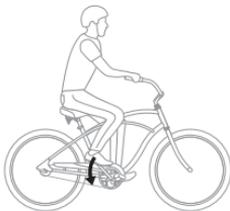
Per la massima potenza di arresto, le pedivelle devono essere orizzontali quando si attiva il freno. Prima che il freno entri in funzione, la pedivella ruoterà leggermente, perciò iniziare ad azionare il freno quando il pedale posteriore è leggermente più in alto rispetto alla posizione orizzontale.
