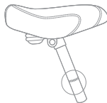
Figure 1.2 : Repère d'insertion minimale de la tige de selle.
