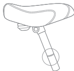
Figura 1.2: La línea de inserción mínima del poste de asiento.
