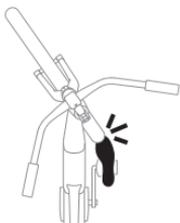
Beim Lenken besteht das Risiko, mit dem Fuß das Vorderrad zu berühren. Wenn du den Lenker bei sehr geringen Geschwindigkeiten einschlägst, kann es passieren, dass du das Vorderrad oder das Schutzblech mit dem Fuß berührst. Trete bei langsamen Geschwindigkeiten und bei eingeschlagenem Lenker nicht in die Pedale.
