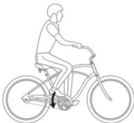
Die höchste Bremskraft wird erreicht, wenn die Kurbelarme beim Betätigen der Bremse waagrecht stehen. Da sich die Kurbel etwas dreht, bevor die Bremse das Fahrrad tatsächlich abbremst, sollte der hintere Kurbelarm zu Beginn des Bremsvorgangs etwas über der Waagerechten liegen.
