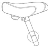
Abb. 1.2: Markierung der minimalen Sattelstütze-einschubtiefe.
