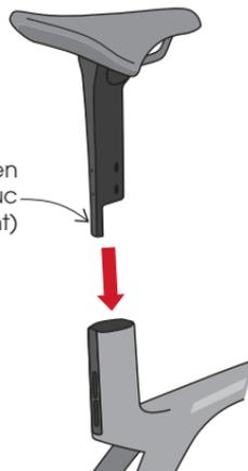
Laissez l'extrémité en caoutchouc à l'intérieur de la tige de selle (celle-ci empêche la tige de selle d'être serrée en position trop basse).
