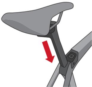
N'abaissez pas la tige de selle complètement jusqu'au point d'arrêt. Il doit y avoir un espace d'au moins 5 mm entre le bas de la tige de selle et le point d'arrêt.
