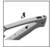
[Cubierta del puerto de carga](#)
