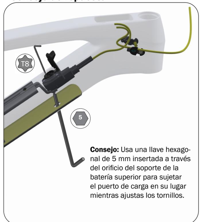
**Consejo:** Usa una llave hexagonal de 5 mm insertada a través del orificio del soporte de la batería superior para sujetar el puerto de carga en su lugar mientras ajustas los tornillos.
