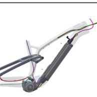
[Kabelverlegung für Bremsen, Schaltwerk und Variosattelstütze](#)
