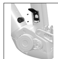
Cubierta del puerto de carga de la batería
