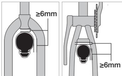
骑行时，轮胎不能接触到前叉、车架或任何零部件，否则轮子会受到侧向载荷的影响而弯曲。
