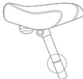
图 1.2: 最低座杆插入线。
