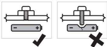
**⚠ 警告：**电气系统短路和/或电池损坏可能会导致过热。在极端情况下，受到严重影响的电池组甚至可能会着火。
