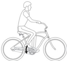
若要施加较大刹车力度，在使用刹车时曲柄臂应处于水平位置。曲柄会在制动器开始工作前稍作旋转，因此开始施加制动力时，后踏板会略高于水平。
