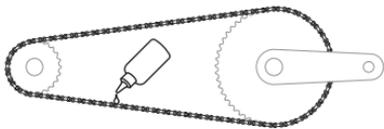
**提示:**将润滑油涂抹在链条的底边上,并在链条下放一块抹布。这样可防止润滑油滴落在您的后下叉(车架)或车轮上,让这个过程更加干净。
