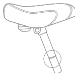
Obrázok 1.2: Minimálna vkladacia línia sedlovky.
