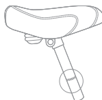
Rysunek 1.2: Ogranicznik maksymalnego wysunięcia sztycy podsiodłowej.
