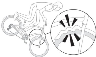
Un garde-boue non autorisé ou mal installé peut provoquer l'arrêt brutal du vélo.
