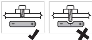
**⚠ AVERTISSEMENT :** Une court-circuit dans le système électrique ou des dommages à la batterie peuvent entraîner une surchauffe. Dans de très rares cas, une batterie fortement endommagée peut s'enflammer.
