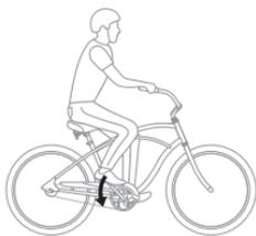
Pour une plus grande force de freinage, les manivelles des pédales doivent être à l'horizontale lorsque vous commencez à freiner. La manivelle tournera légèrement avant que le frein ne soit activé. Commencez donc à freiner lorsque la pédale arrière est légèrement plus haute que l'horizontale.
