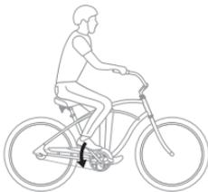
Para lograr la mayor fuerza de frenado, los brazos de la biela deben estar en posición horizontal cuando aplicas el freno. La biela girará un poco antes de que el freno empiece a trabajar, así que comienza a aplicar el freno con el pedal trasero ligeramente más alto que la posición horizontal.
