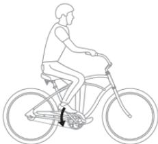
Para frenar con la máxima potencia, los brazos de la biela deben estar en posición horizontal al accionar el freno. La biela girará un poco antes de que el freno empiece a funcionar, por lo que deberás empezar a frenar con el pedal trasero situado en una posición ligeramente más alta en relación al plano horizontal.
