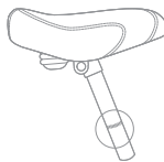
Abb. 1.2: Markierung der minimalen Sattelstütze-einschubtiefe.
