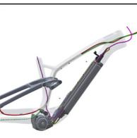
[Brake, dérailleur and dropper post routing](#)
