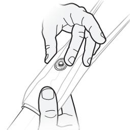
4. Instale o o-ring (2) na porca do corpo do amortecedor (1).
