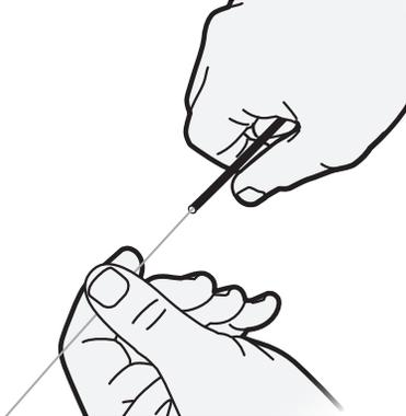
4. No IsoStrut, deslize a ponteira pelo fio.
