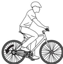
Pour une plus grande force de freinage, les manivelles des pédales doivent être à l'horizontale lorsque vous commencez à freiner. La manivelle tournera légèrement avant que le frein ne soit activé. Commencez donc à freiner lorsque la pédale arrière est légèrement plus haute que l'horizontale.
