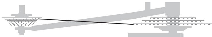
Ketjun linja suurelta rattaalta suurelle rattaalle
