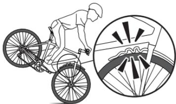
Un guardabarros no homologado o mal instalado puede hacer que la bicicleta se detenga repentinamente.
