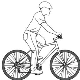
Si la pierna se dobla demasiado, el sillín debe colocarse a mayor altura. Si no puedes alcanzar el pedal, el sillín debe colocarse a menor altura.
