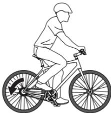
Para frenar con la máxima potencia, los brazos de la biela deben estar en posición horizontal al accionar el freno. La biela girará un poco antes de que el freno empiece a funcionar, por lo que deberás empezar a frenar con el pedal trasero situado en una posición ligeramente más alta en relación al plano horizontal.
