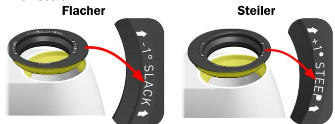
3. Die untere Schale so positionieren, dass sie mit dem Winkel der oberen Schale übereinstimmt.
