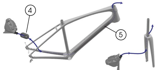
3. Fixer les étriers sur la base arrière et sur la fourche sans les serrer (cela permettra d'éviter le glissement des durites).
