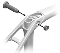
IsoSpeed: demontaż części montaż
