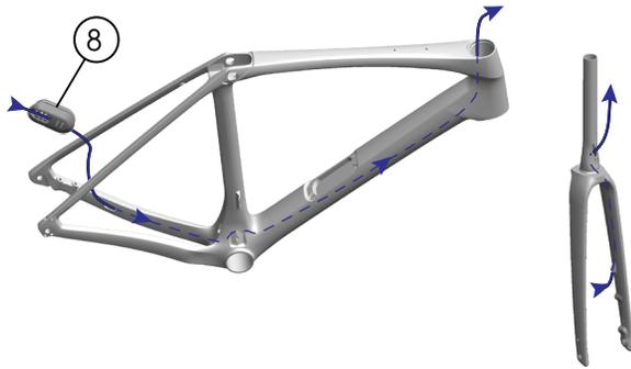
2. Acheminer les câbles Di2 dans le cadre et les connecter à la batterie.
