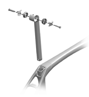
Poste de asiento
