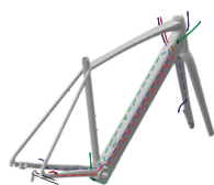
Dragning av kablage och slang till broms/växel
