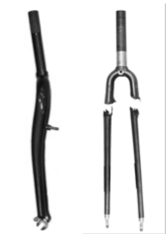
図 1. 過負荷を掛けたフォーク：左の金属製フォークは過負荷をかけると曲がります。右側のカーボンフォークは、より高い負荷まで耐えたのち、完全に破断しました。
