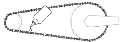
Figura 2.3: Applicare lubrificante sulla sezione inferiore della catena.
