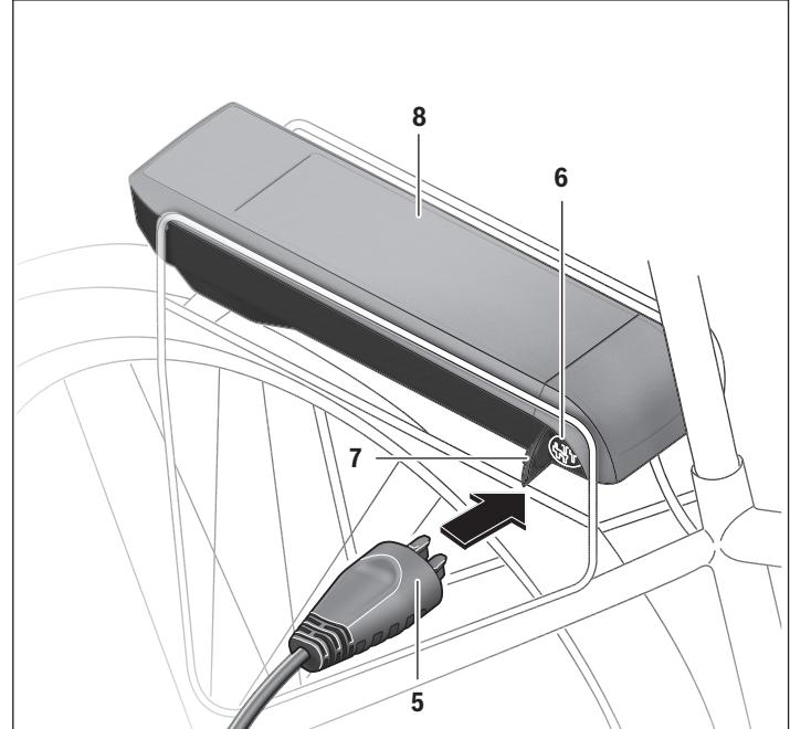
Eteignez l'accu. Nettoyez le couvercle de la prise de charge **7**. Évitez tout encrassement de la prise de charge et des contacts, par ex. par du sable ou de la terre. Soulevez le couvercle de la prise de charge **7** et connectez la fiche de charge **5** à la prise de charge **6**.
