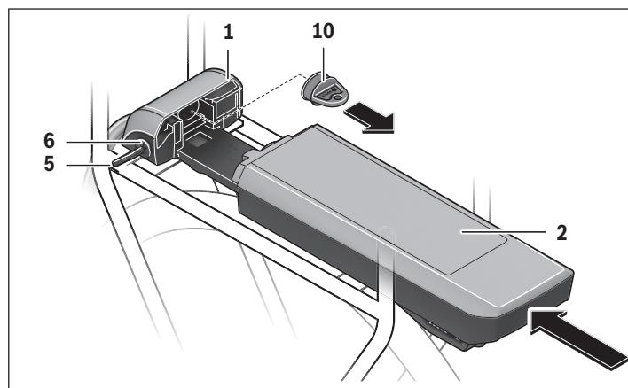
► **Toujours arrêter le système eBike et éteindre l'accu pour insérer ce dernier dans sa fixation ou l'extraire de sa fixation.**
