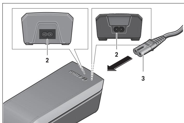
► **Respectez la tension du secteur !** La tension de l'alimentation doit correspondre aux données indiquées sur la plaque signalétique du chargeur de batterie.
