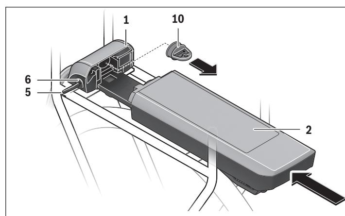
► **Desconecte siempre la batería y el sistema eBike para montar o retirar la batería del soporte.**
