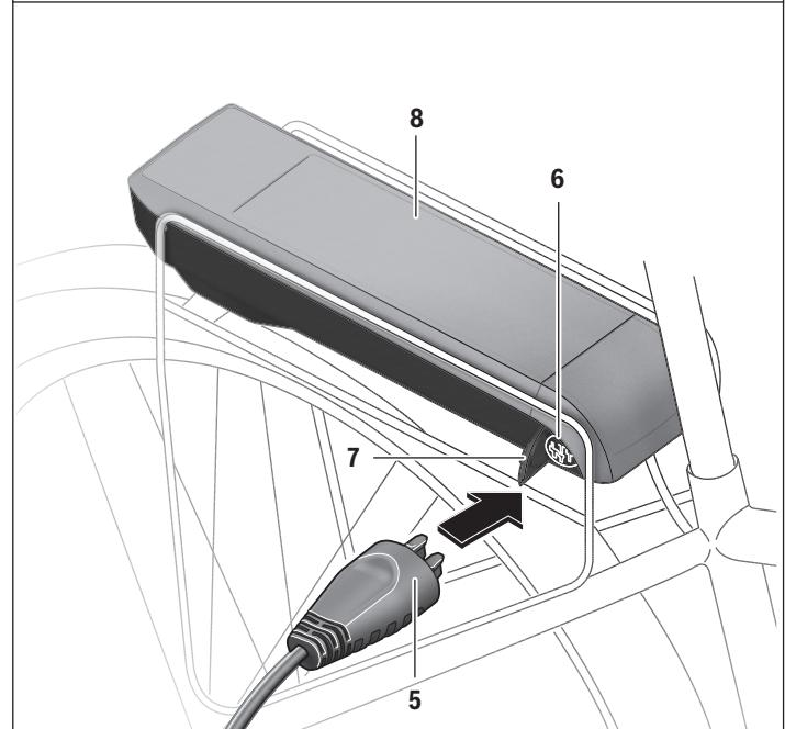
Apague el acumulador. Limpie la cubierta del conector hembra para carga **7**. Ponga especial cuidado de no ensuciar el conector hembra para carga ni los contactos con arena o tierra, p. ej. Levante la cubierta del conector hembra para carga **7** y conecte el conector macho del cargador **5** al conector hembra para carga **6**.
