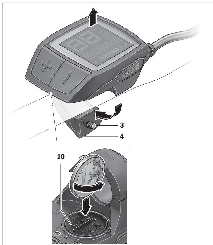
Si el ordenador de a bordo muestra “**LOW BAT**” en la pantalla, retírelo del manillar desenroscando el tornillo de fijación **3**. Abra la tapa del compartimento para baterías **10** con una moneda adecuada, extraiga las pilas gastadas y coloque pilas nuevas del tipo CR 2016. Puede adquirir las baterías recomendadas por Bosch en su establecimiento especializado.
