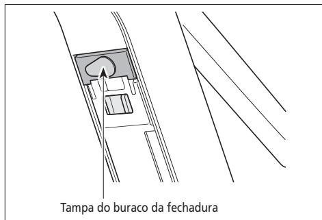
**2.** Insira a chave no cilindro da chave existente no suporte da bateria.
