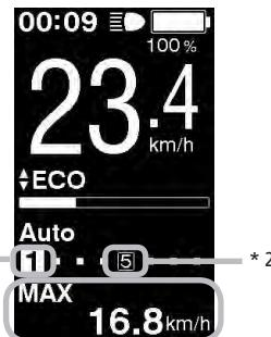
\*1 Posición de la marcha (solo se muestra cuando se utiliza el cambio de marchas electrónico)
