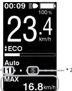
\*1 Gearposition (bliver kun vist med elektronisk gearsift)
