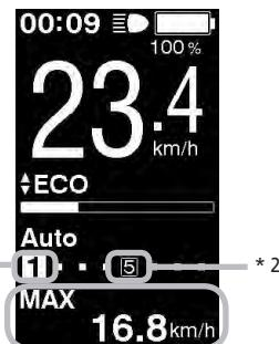
\*1 Växelläge (visas endast när elektronisk växling används)
